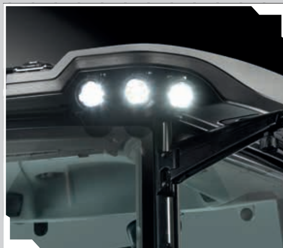
Nuovo design del tetto con fino a 12 luci da lavoro a LED.
