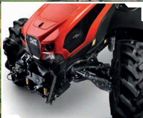
Sospensione anteriore a ruote indipendenti ActiveDrive.
