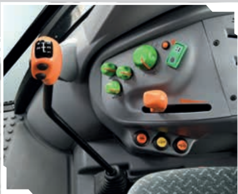
Sollevatore posteriore elettronico con ammortizzamento delle vibrazioni.
