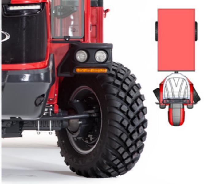
La version ST (ruote sterzanti) è equipaggiata con lo sterzo idraulico sulle ruote anteriori. Le trattori della serie EVO 4 sono caratterizzati da un baricentro basso e nella versione a ruote sterzanti garantiscono la massima stabilità in condizioni estreme e in forti pendenze. Le sterzanti della gamma CARON sono disponibili con varie misure di passi e larghezza.
