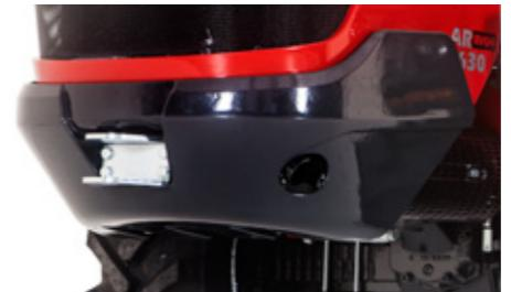
Il paraurti della serie EVO4 è una fusione di alluminio disegnata per avvolgere e proteggere la parte anteriore del motore, particolare attenzione è stata dedicata all'angolo di attacco
