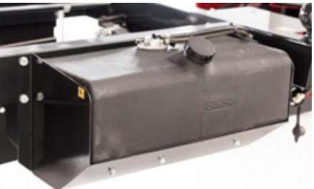
Serbatoio in plastica con protezione in lamiera
