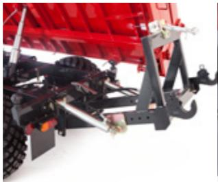
Porta-attrezzi posteriore idraulico con attacco a tre punti, removibile, adatto al trasporto di attrezzature ad esempio gru / caricatori forestali, verricelli, spaccalegna, seghe...
