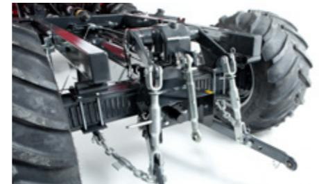
Sollevatore con leveraggi per attacco a tre punti posteriore con coppia di sollevamento max di 500 kgm
