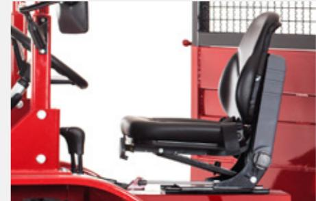
Il sedile di guida con molleggio meccanico dispone di ampie regolazioni e permette di trovare la posizione migliore per lavorare
